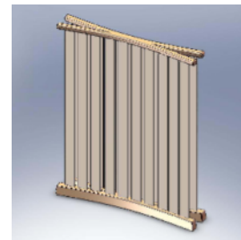
図1 杉製パーテーション3次元CADデザイン図
